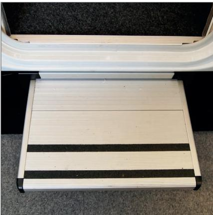
Elektrische Trittstufe mit automatischer Einfahrfunktion
